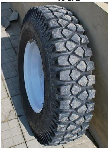
2. Запрещается применение шин, имеющих отслоения протектора и повреждения каркаса. Глубина протектора должна быть не менее 2мм.
