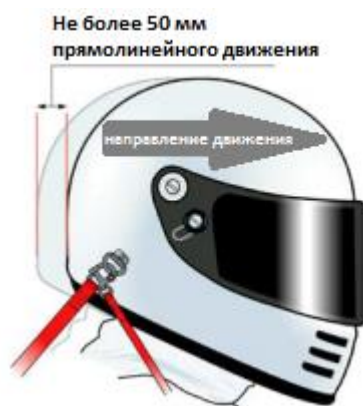
Рис.4. Регулировка лямок по свобода прямолинейного перемещения вперед (не более 50 мм)
