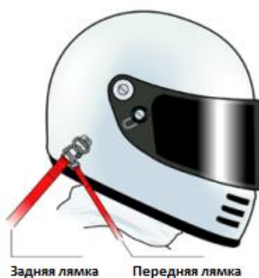
Рис.3. Задняя (слева) и передняя (справа) ляпки устройства HYBRID
