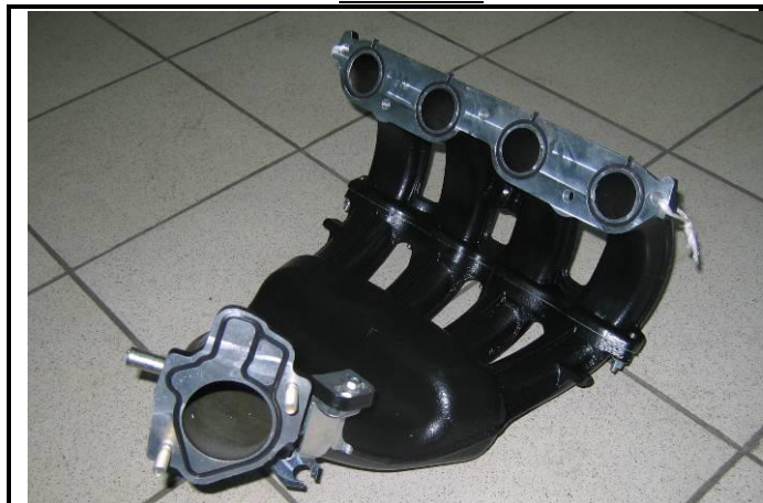
C11-2) Впускной коллектор - демонтированный Intake manifold - dismounted
