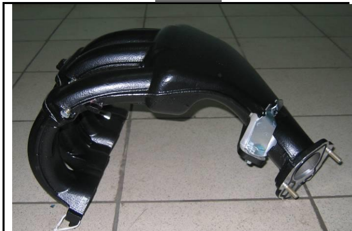
C11-1) Впускной коллектор - демонтированный Intake manifold - dismounted
