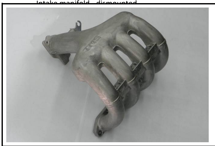
C11-1) Впускной коллектор - демонтированный Intake manifold - dismounted
