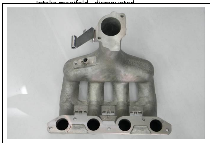
C11-2) Впускной коллектор - демонтированный Intake manifold - dismounted
